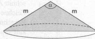
Die Abwicklung der Mantelfläche eines Kreiskegels ist ein **Kreisbogen** mit **Mittelpunktswinkel  $\varphi$** . Der Radius dieses Sektors ist die Mantellinie m des Kegels. Die Länge des Kreisbogens b entspricht dem Umfang u des Grundkreises. Die Mantelfläche M des Kegels entspricht der Fläche des Kreisbogens.
