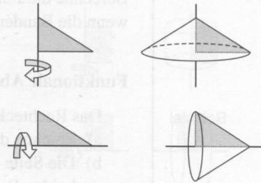
Der Axialschnitt eines Kegels ist ein gleichschenkliges Dreieck. Dessen gleich lange Schenkel werden als **Mantellinien m** bezeichnet. Sie schließen den sogenannten **Öffnungswinkel  $\alpha$**  an der Spitze des Kegels ein.
